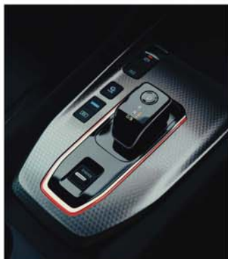
Schimbător de viteze specific e-POWER [1]
